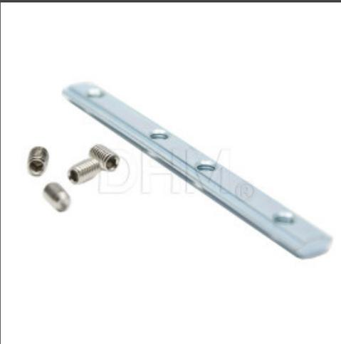
La confezione contiene: 1 x Dado lungo di pre-montaggio con fori M5 - Serie 5 Il dado in oggetto è adatto all'utilizzo con profili estrusi di alluminio. Si può utilizzare con profili della serie 5 quali 20 x 20 mm e 20x40 mm, che abbiano cava da 6 mm. Sono da inserire prima del montaggio del profilo. Foro maschiato filettato che permette di fissare il dado con la rispettiva vite. Sono adatto al fissaggio di una guida lineare al profilo.
