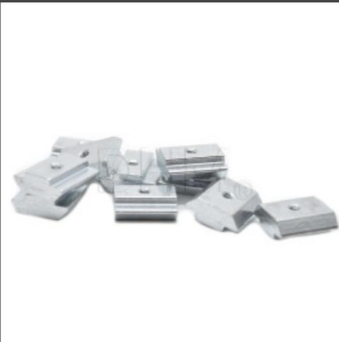
La confezione contiene: 10 x Dadi di pre-montaggio M3 - Serie 6 I dadi in oggetto sono adatti all'utilizzo con profili estrusi di alluminio. Si possono utilizzare con profili serie 6, e che abbiano cava da 8 mm. Sono da inserire prima del montaggio del profilo. Foro maschiato filettato che permette di fissare il dado con la rispettiva vite.
