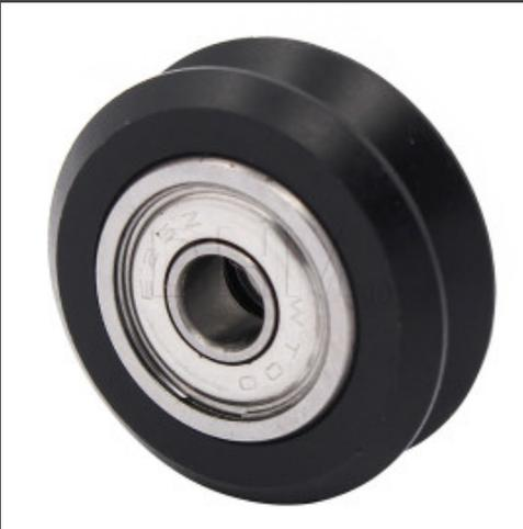
La confezione contiene: 1 x Delrin Big W wheel 625ZZ Ruota in delrin ideale per l'utilizzo con profili di alluminio nelle movimentazioni di stampanti 3D, ma anche altri progetti. Permette di lavorare con alta precisione e tolleranza. Adatta per profili 20x20. Foro interno 5 mm. Cuscinetto 625zz.
