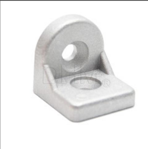
La confezione contiene: 1 x Staffa di rotazione 90° per profilato serie 6 I profilati in alluminio possono essere collegati tra loro tramite staffa. Questo collegamento prevede l'inserimento dei dadi nelle cave dei profili e il fissaggio con le viti. La staffa in oggetto non è caratterizzata da alette e permette di posizionare i profili in diverse posizioni.
