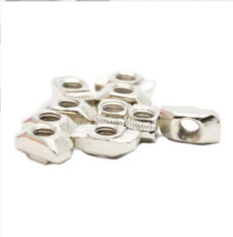
La confezione contiene: 10 x Dadi di post-montaggio M6 - Serie 6 I dadi in oggetto sono adatti all'utilizzo con profili estrusi di alluminio. Si possono utilizzare con profili serie 6 che abbiano cava da 8 mm. Si possono inserire anche durante o dopo il montaggio del profilo. Foro maschiato filettato che permette di fissare il dado con la rispettiva vite.
