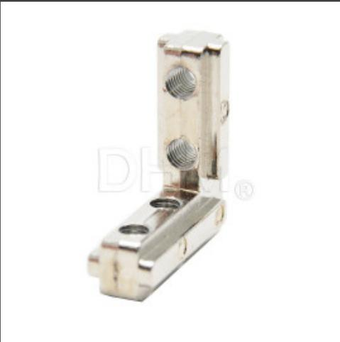
La confezione contiene: 1 x Staffa a scomparsa 90° T slot per profilato serie 8 I profilati in alluminio possono essere collegati tra loro tramite giunti a scomparsa. Questo permette si creino linee pulite senza interferenze. Le staffe a scomparsa in oggetto sono subito montabili sui profili di alluminio. Si fissano con viti alla cava del profilo per fare un collegamento a L.
